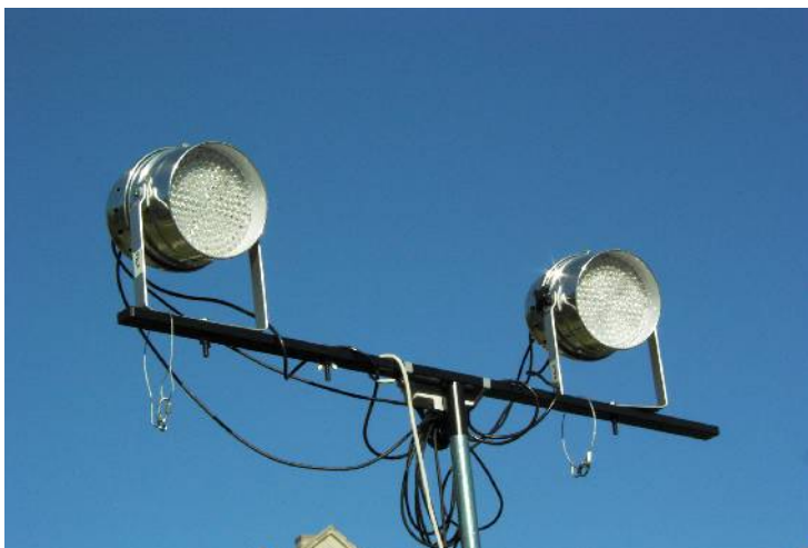
Projecteurs à LED 32 Watts équivalents 350 Watts - Festival Pose tes tongs, Niort – édition 2008.
