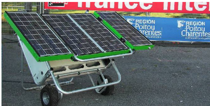
Groupe électrogène photovoltaïque. Musiques méti- ses, Angoulême - édition 2009.
